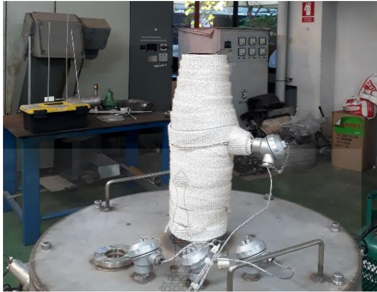
รูปที่ 3.10 ตำแหน่งการวัดอุณหภูมิของการทดสอบใช้จริงกับห้องเผาไหม้เครื่องกำเนิดไอน้ำแบบท่อชุด
