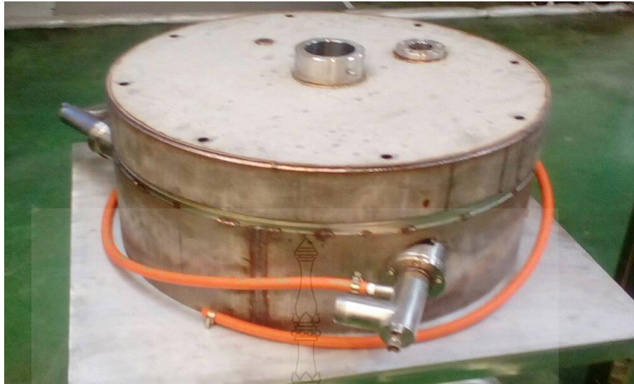
รูปที่ ค.7 การประกอบโครงสร้างเข้ากับห้องเผาไหม้
