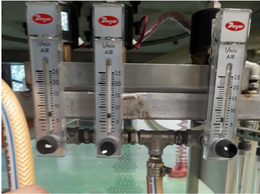
รูปที่ ค.11 การติดตั้งระบบป้อนแก๊สแยก 3 ช่องทาง
