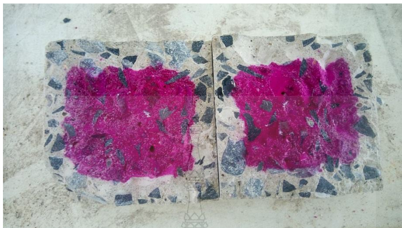
รูปที่ 4.15 ตัวอย่างของคอนกรีตที่ทดสอบการเกิดคาร์บอนเนชั่นโดยใช้น้ำยาฟีนอล์ฟทาลินในแอลกอฮอล์ ฉีดลงบนผิวคอนกรีตที่เผชิญก๊าซคาร์บอนไดออกไซด์
