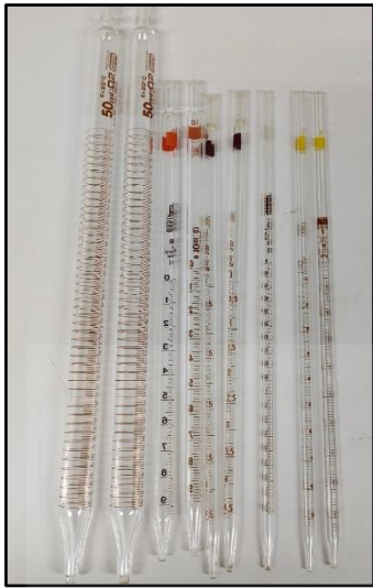
ปิเปตต์ (Pipette) ใช้ในการดูดสารละลาย ที่ต้องการปริมาตรที่แน่นอน และมีความแม่นยำสูง
