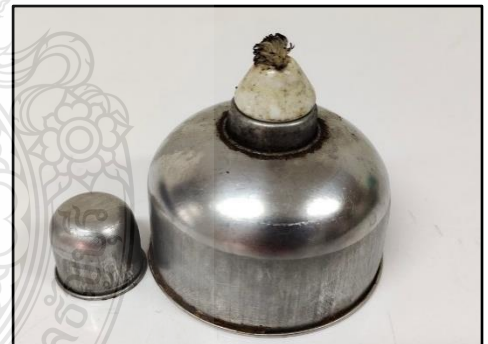
ตะเกียงแอลกอฮอล์ (Turnel) ใช้ สำหรับใส่แอลกอฮอล์ 95 % ในการเผามีดผ่าตัด และปากคีบ
