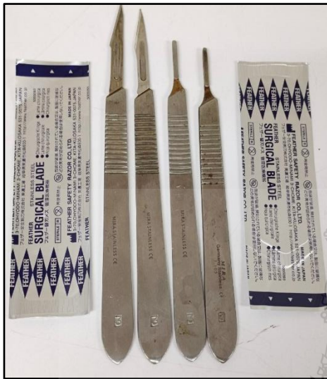
ด้ามมีดและใบมีดผ่าตัด (Knives and Scalpel) ใช้สำหรับตัดย้ายเนื้อเยื่อพืช ครอบหรือนึ่งฆ่าเชื้อก่อนนำไปใช้งาน
