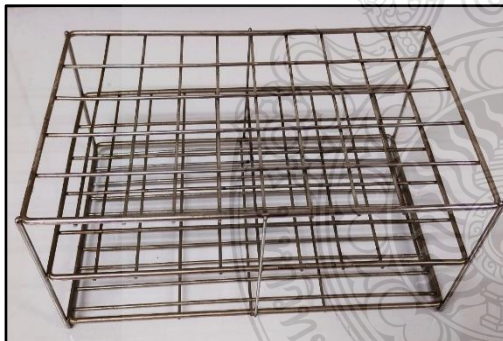
ตะแกรงสแตนเลส (Rack) ใช้สำหรับ วางมีดผ่าตัดและปากคีบ
