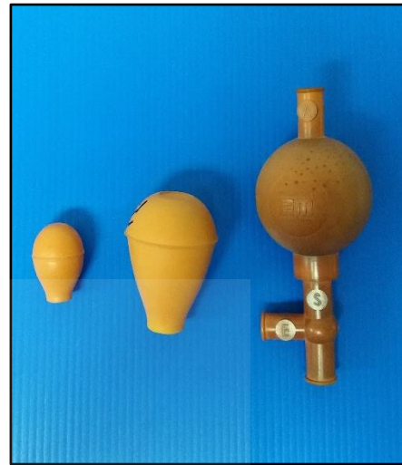
ลูกยางดูด (Pipette bulb) ใช้ในการดูดสารใส่ปิเปตต์
