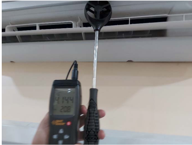
รูปที่ 4.12 แสดงการวัดค่าปริมาณลมผ่านเข้าและออกอีวาพอเรเตอร์
