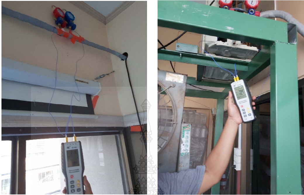
รูปที่ 4.5 แสดงการวัดค่าอุณหภูมิของสารทำความเย็น
