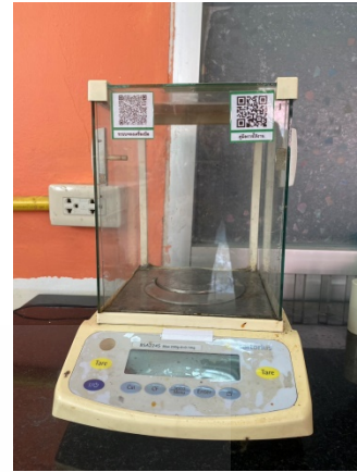
ภาพที่ 4.33 แสดงตัวอย่างเครื่องชั่งละเอียด
