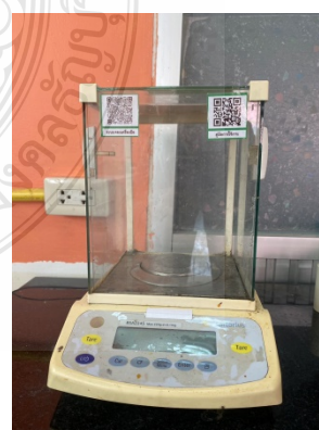
ภาพที่ 4.57 แสดงตัวอย่างเครื่องชั่ง 4 ตำแหน่ง
