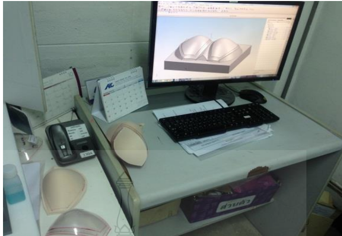
รูปที่ 2.36 โปรแกรมออกแบบหัวแม่พิมพ์ฟองน้ำเป็นฟองโมลด์สี่ชั้นในสตรี
