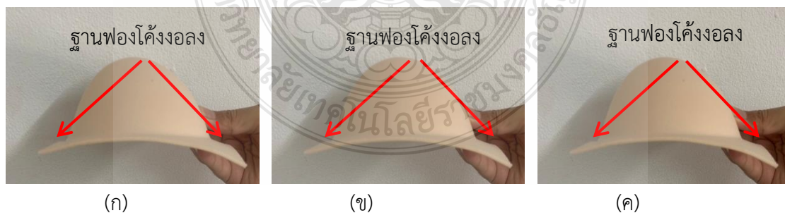
รูปที่ 4.21 (ก) ระยะเวลา 90 วินาทีและอุณหภูมิ190/200 (บน,ล่าง) องศาเซลเซียส (ข) ระยะเวลา 90 วินาทีและอุณหภูมิ 200/205 (บน,ล่าง) องศาเซลเซียส (ค) ระยะเวลา 90 วินาทีและอุณหภูมิ 205/210 (บน,ล่าง) องศาเซลเซียส
