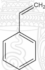
รูปที่ 2.11 สูตรทางเคมีและลักษณะโครงสร้างของสไตรีน [38]
