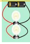
รูปที่ 1 วงจรแบบขนาน ที่มา : www.kksci.com
