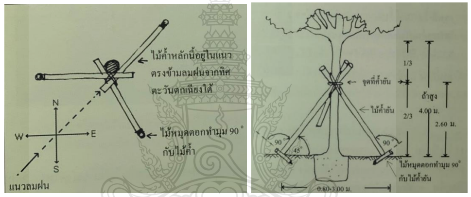
ภาพที่ 4.37 การค้ำยันแบบกระโจม 3 เสา ที่มา : เอื้อมพร วิสมหมาย (2544)
