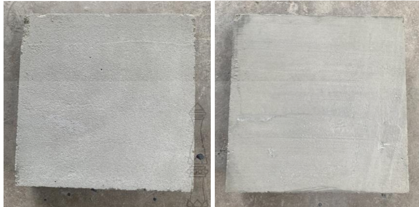
ภาพที่ 4.48 ผลงานการทำแผ่นทางเท้าที่เสร็จสมบูรณ์ (ซ้าย) แบบขัดหยาบ (ขวา) แบบขัดมัน
