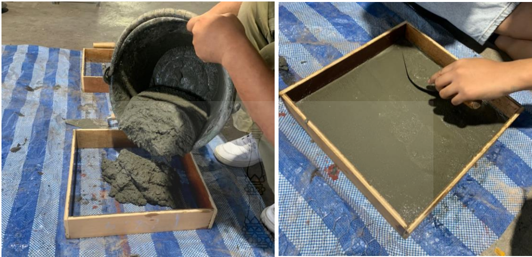
ภาพที่ 4.39 ขั้นตอนการเทคอนกรีตลงในแบบไม้
