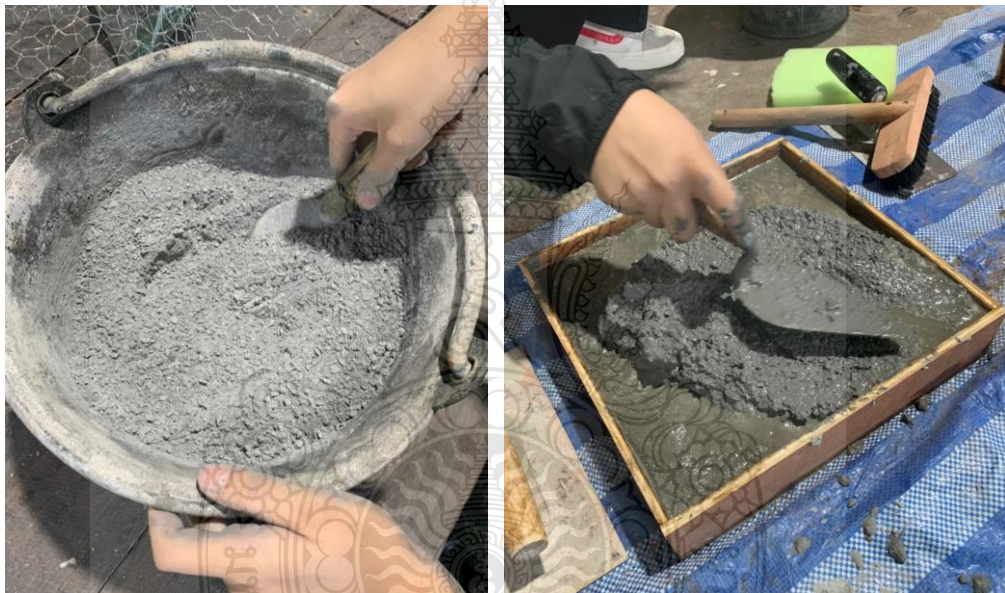
ภาพที่ 4.41 ขั้นตอนการผสมและการเทชั้นทรายล้า
