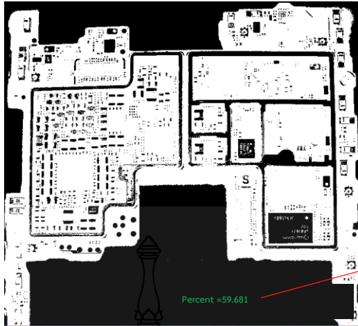
รูปที่ 3.9 ภาพลักษณะการนับพิกเซลที่ได้จากกล้องอุตสาหกรรม
