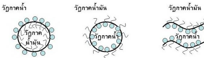
ภาพที่ 1.1 แบบจำลองโครงสร้างของไมโครอิมัลชัน: (ก) ประเภทน้ำมันในน้ำ (ข) ประเภทน้ำในน้ำมัน และ (ค) ประเภทต่อเนื่องแบบคู่ [4]
