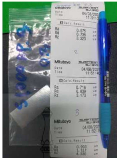
ข.9 ผลการวัดความหยาบของชิ้นทดสอบที่มีความเร็วรอบของหัวกด 1000 รอบ/นาที ความลึกในการป้อน 0.3 มิลลิเมตร/รอบ
