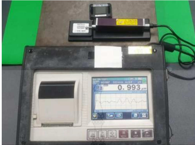
ข.1 การสอบเทียบเครื่องวัดความหนาให้พร้อมวัดความหนาผิว
