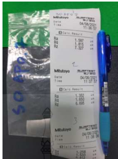
ข.5 ผลการวัดความหยาบของชิ้นทดสอบที่มีความเร็วรอบของหัวกด 0 รอบ/นาที ความลึกในการป้อน 0.7 มิลลิเมตร/รอบ
