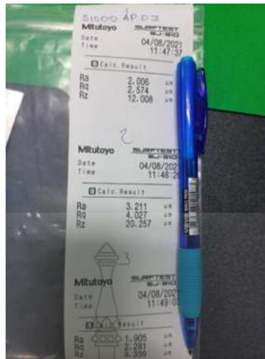
ข.11 ผลการวัดความหยาบของชิ้นทดสอบที่มีความเร็วรอบของหัวกด 1000 รอบ/นาที ความลึกในการป้อน 0.7 มิลลิเมตร/รอบ
