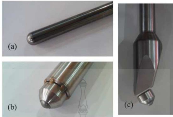
รูปที่ 2.9 ลักษณะของ Forming tool (a) Rigid (b) VRB และ (c) ORB
