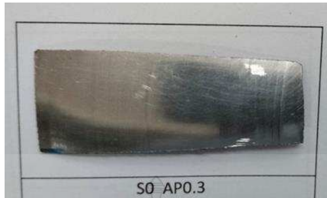
ก.1..ชั้นทดสอบที่มีความเร็วรอบของหัวกัด 0 รอบ/นาที ความลึกในการป้อน 0.3 มิลลิเมตร/รอบ
