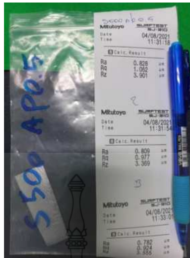
ข.7 ผลการวัดความหยาบของชิ้นทดสอบที่มีความเร็วรอบของหัวกัด 500 รอบ/นาที ความลึกในการป้อน 0.5 มิลลิเมตร/รอบ
