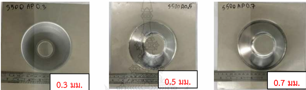
ค.2..ชิ้นงานที่มีความเร็วรอบของหัวกด 500 RPM ความลึกในการป้อน 0.3,0.5 และ0.7 มม.
