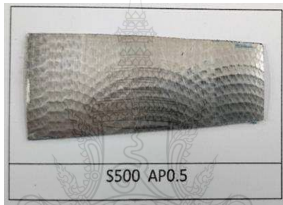
ก.5..ชั้นทดสอบที่มีความเร็วรอบของหัวกัด 500 รอบ/นาที ความลึกในการป้อน 0.5 มิลลิเมตร/รอบ
