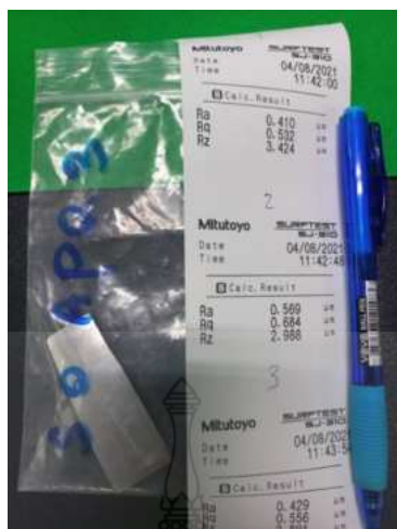
ข.3 ผลการวัดความหยาบของชิ้นทดสอบที่มีความเร็วรอบของหัวกด 0 รอบ/นาที ความลึกในการป้อน 0.3 มิลลิเมตร/รอบ
