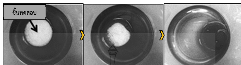
รูปที่ 3.10 วิธีการทดสอบความสามารถในการดูดซับน้ำมัน
