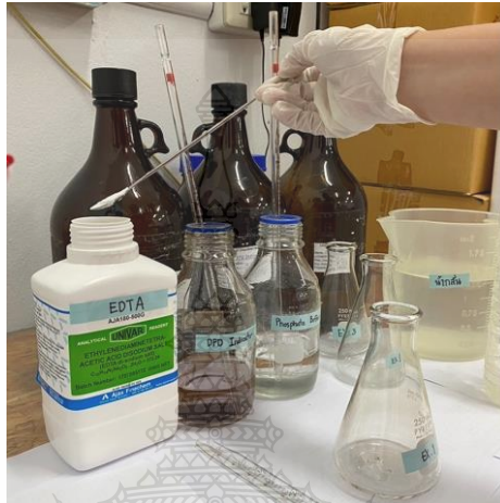
รูปที่ 4.14 แสดงการไตเตรทเพื่อหาค่าปริมาณความเข้มข้นของก๊าซไอโซนในน้ำที่ใช้ในการศึกษา
