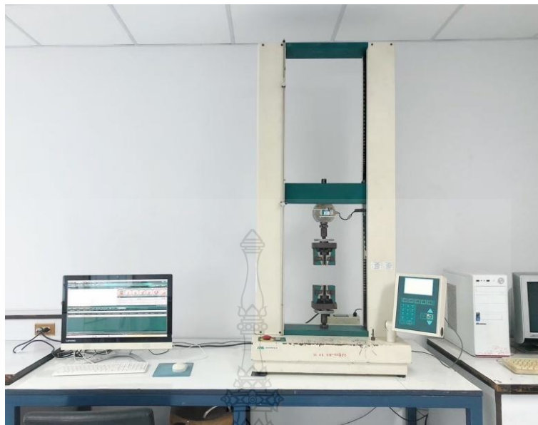
ภาพที่ 3.14 เครื่องทดสอบยูนิเวอร์แซล (Hounsfield H 50 KS)
