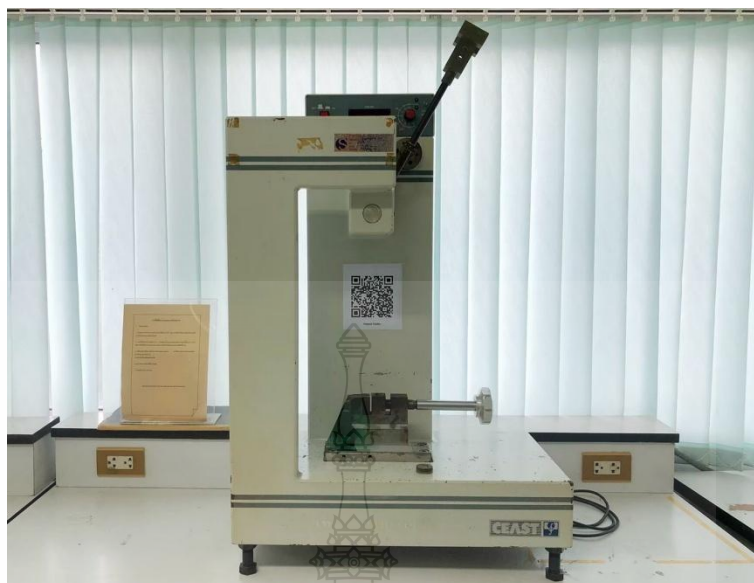
ภาพที่ 3.12 เครื่องทดสอบความทนแรงกระแทกแบบไอซอด (Ceast)
