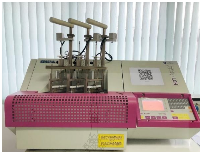
ภาพที่ 2.21 เครื่องวัดอุณหภูมิแอนตัวภายใต้สภาวะการรับน้ำหนักและความร้อน (Heat Distortion Temperature, HDT) CEAST 6911
