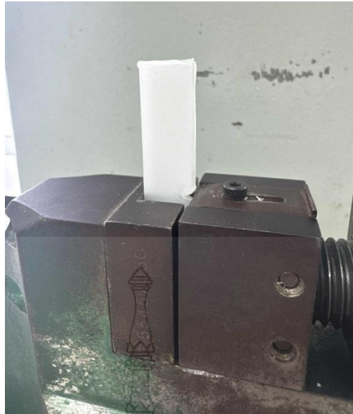
รูปที่ 3.4 รูปแบบการวางชิ้นทดสอบสำหรับการทดสอบความทนแรงกระแทกแบบ Izod [31]
