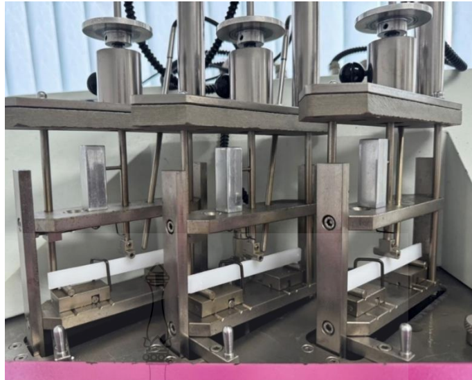
รูปที่ 3.11 ตัวอย่างการทดสอบอุณหภูมิโก่งตัวด้วยความร้อน [31]
