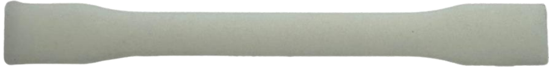
รูปที่ 3.7 ตัวอย่างชิ้นทดสอบ HDPE รูปดัมเบลล์สำหรับทดสอบสมบัติความทนแรงดึง
