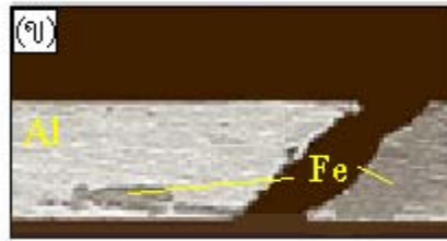
รูปที่ 4.20 โครงสร้างมหภาคแสดงตำแหน่งการพังทลายของชิ้นงานเชื่อมที่ความเร็วรอบ 500 rpm ความเร็วเดินแนวเชื่อม 150 mm/min
