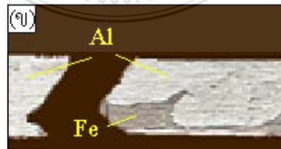
รูปที่ 4.22 โครงสร้างมหภาคแสดงตำแหน่งการพังทลายของชิ้นงานเชื่อมที่ความเร็วรอบ 500 rpm ความเร็วเดินแนวเชื่อม 200 mm/min
