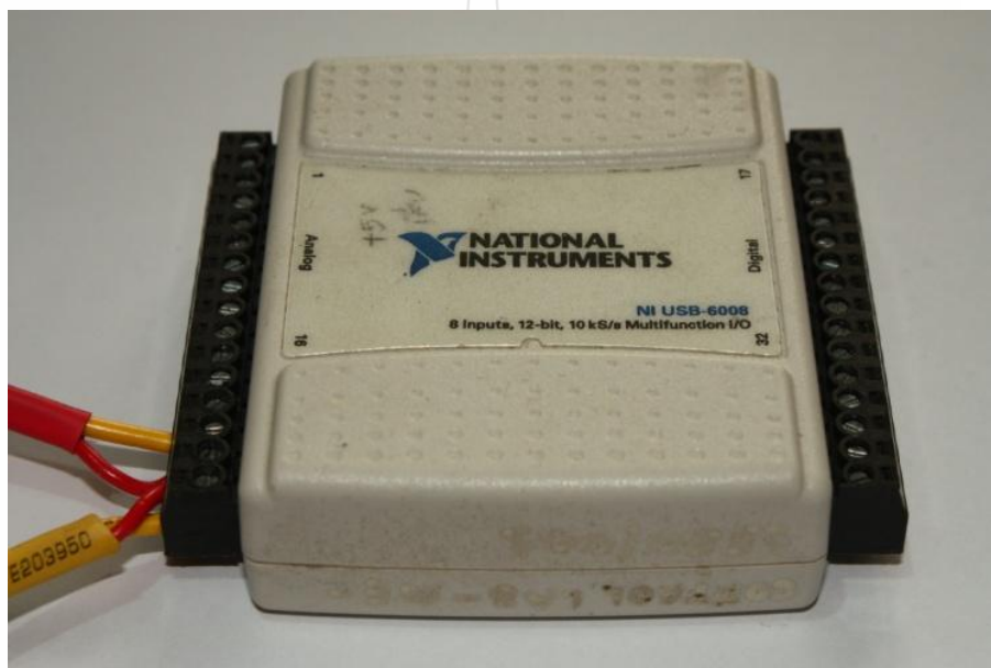
รูปที่ 3.2 USB 6008 ใช้รับสัญญาณ และส่งสัญญาณ
