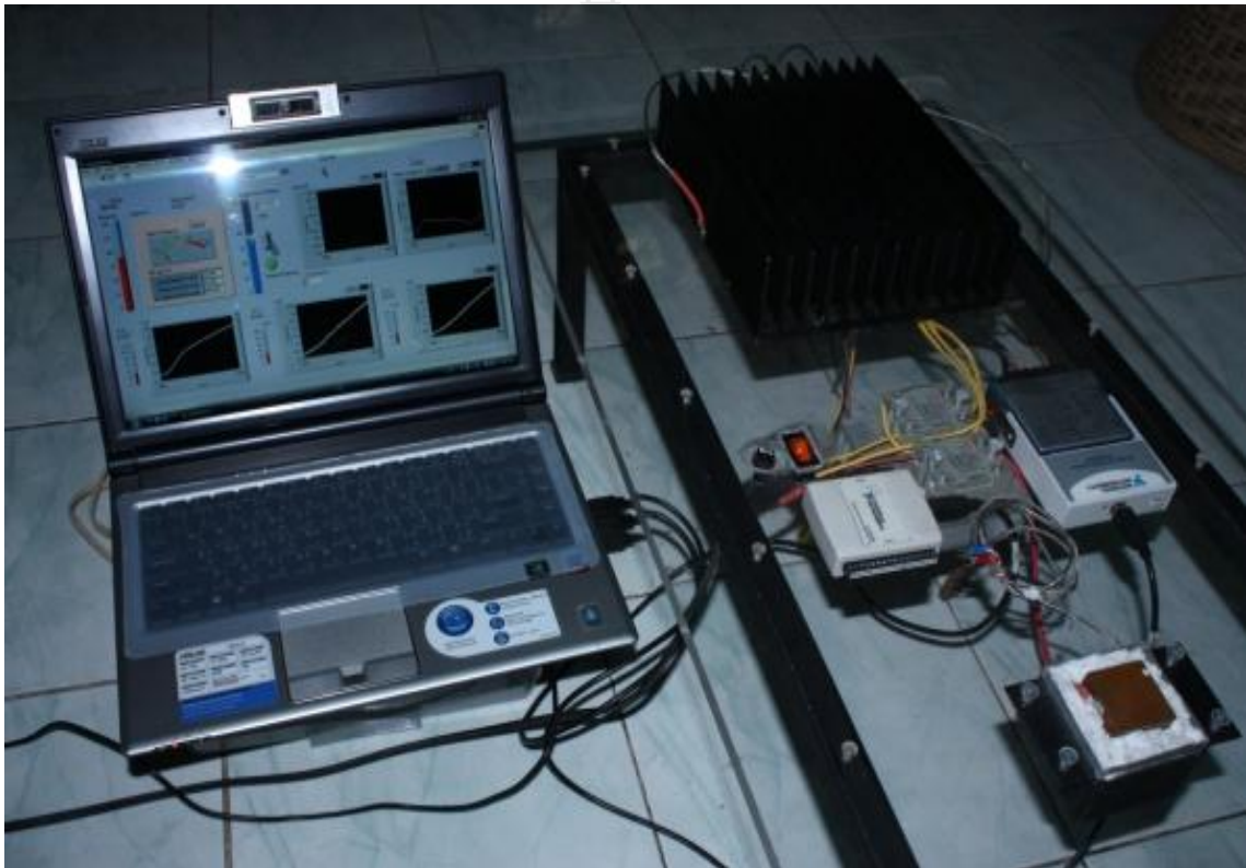
รูปที่ 3.11 ชุดทดสอบระบบระบายความร้อนในการผลิตไฟฟ้าด้วยแผ่นเพลเทียร์
