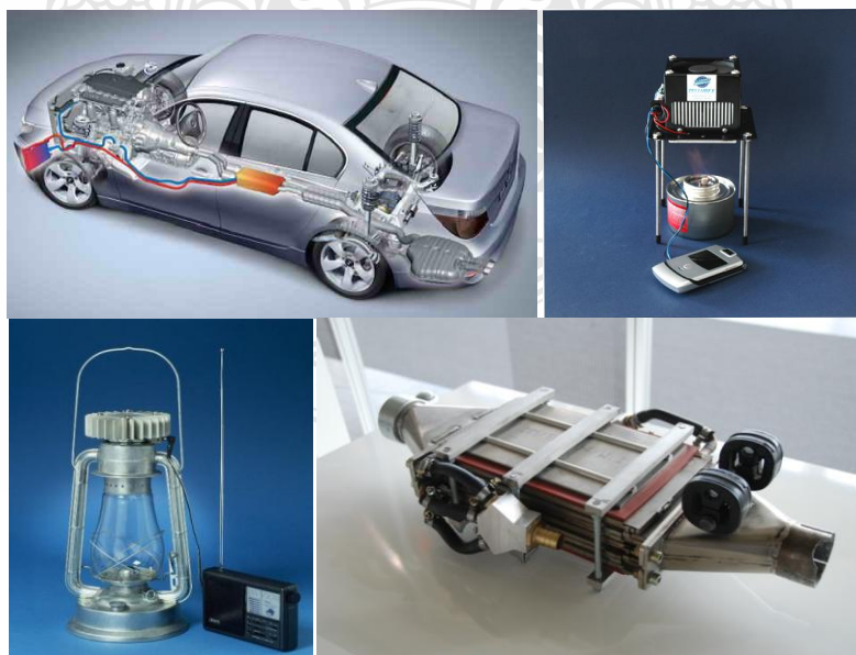
รูปที่ 5.1 การนำโมดูลเพลเทียร์ไปใช้ประโยชน์ในลักษณะงานต่างๆ
