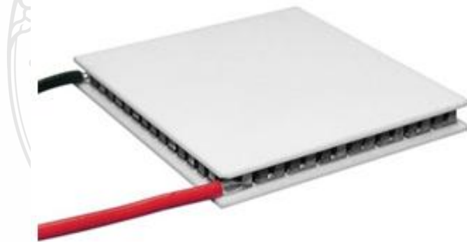
รูปที่ 2.5 เทอร์โมอิเล็กทริกแบบชั้นเดียว (Single stage module) [3]
