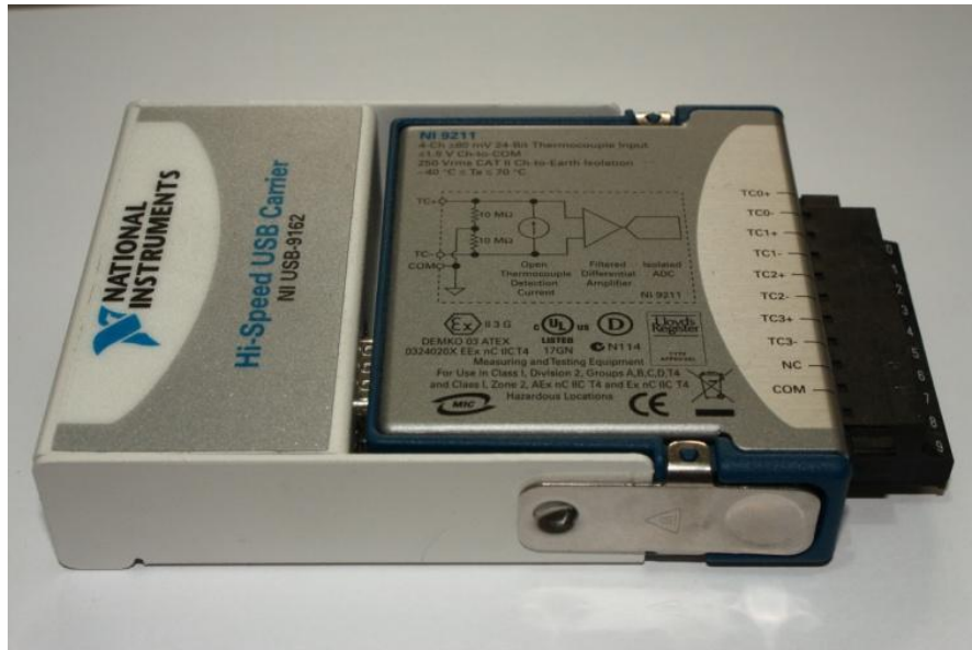
รูปที่ 3.3 NI 9112 อุปกรณ์ใช้ขยายสัญญาณ เทอร์โมคัปเปิล
