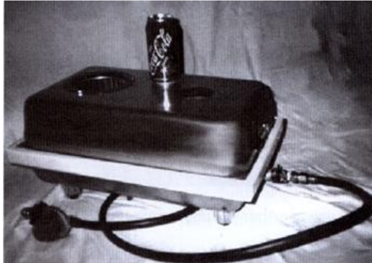
รูปที่ 2.19 เครื่องกำเนิดไฟฟ้าเทอร์โมอิเล็กทริก ที่ผลิตจำหน่ายเชิงพาณิชย์ ขนาดของเครื่องเมื่อเทียบกับกระป๋องน้ำอัดลม [7]
