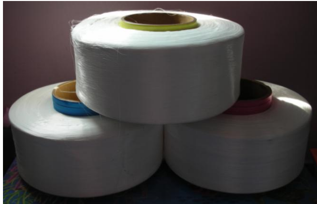
รูปที่ 3.2 ตัวอย่างของเส้นด้ายพอลิเอสเตอร์สำหรับตีเกลียว
