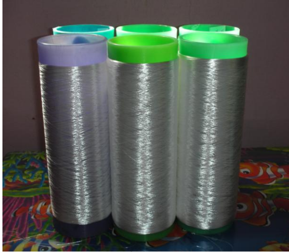
รูปที่ 3.4 ตัวอย่างเส้นด้ายที่เกลิยระหว่างเส้นด้ายไหมกับเส้นด้ายพอลิเอสเตอร์ (50%:50 %)
