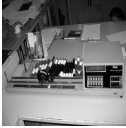
รูปที่ 22 การทดสอบจำนวนเกลียวต่อนิ้วในเส้นด้าย ด้วยเครื่อง Micro Processor Twist Tester
