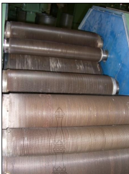
ภาพที่ 3.18 ลูกกลิ้งหมามภายในเครื่องกระจายเส้นใย
