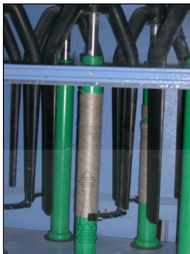
ภาพที่ 3.32 การพันเข้าหลอดของเส้น โรฟวิ่ง
