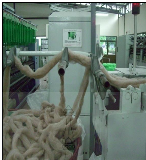
ภาพที่ 3.27 การนำเส้นสไลเวอร์ขนสุนัขเข้าเครื่องรีดปุย
