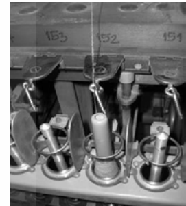
รูปที่ 19 เส้นด้ายพันเข้าแกนหลอดด้าย
