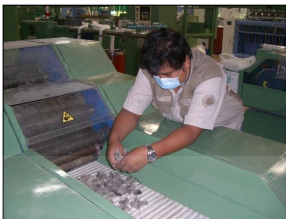
ภาพที่ 3.16 การฉีกเส้นใยขนสุนัขให้กระจายตัว
