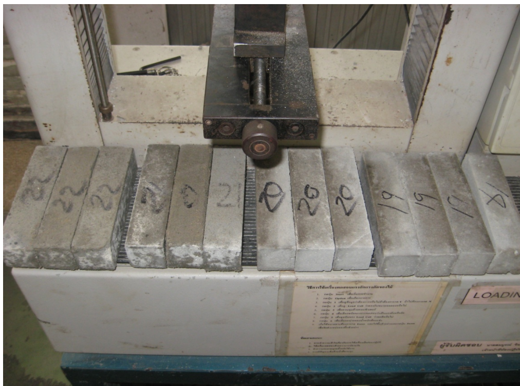
รูปผนวกที่ ค9 รูปมอร์ตาร์ที่ใช้ทดสอบกำลังรับแรงดัด 4x4x16 เซนติเมตร
