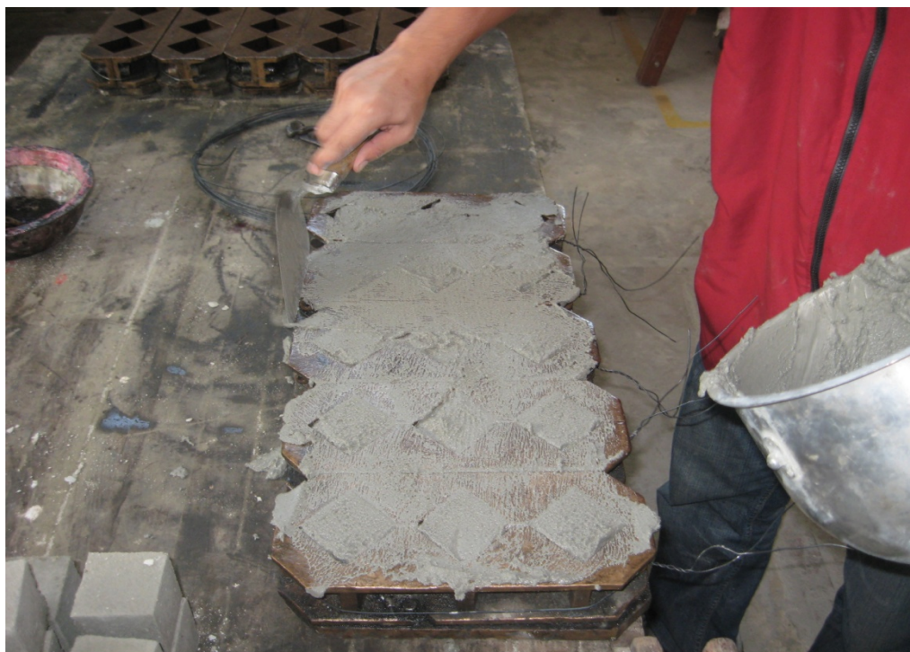
รูปผนวกที่ ค3 การเทมอร์ต้าวในแบบขนาด 5×5 เซนติเมตร
