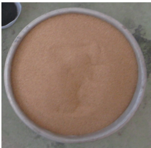
รูปที่ 3.2 ทราขหายาบร้อนผ่านตะแกรงเบอร์ 30
