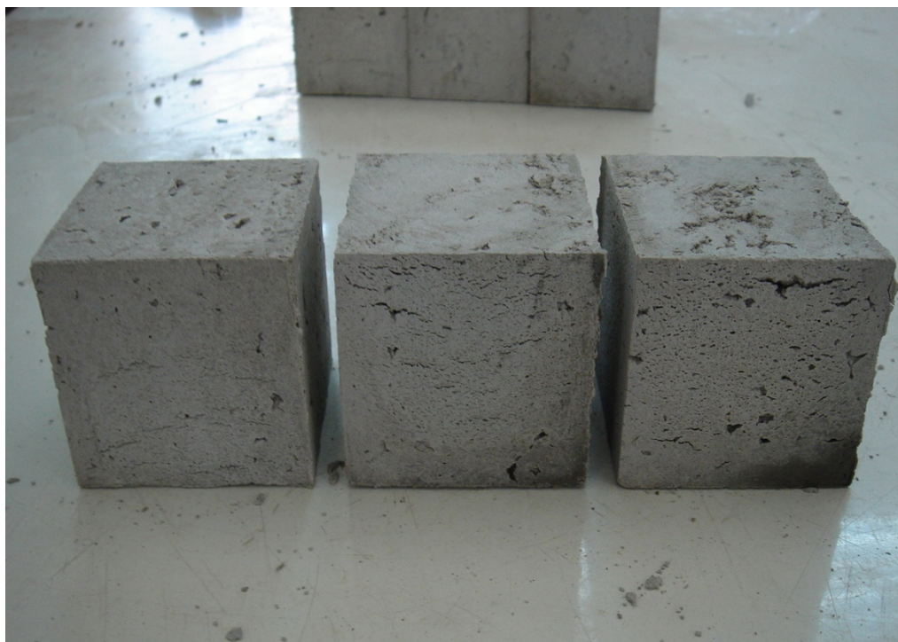
รูปผนวกที่ ค5 รูปมอร์ตาร์ที่ใช้ทดสอบกำลังรับแรงอัด ค่าความหนาแน่น และค่าการดูดซึมน้ำ ขนาด 5x5x5 เซนติเมตร
