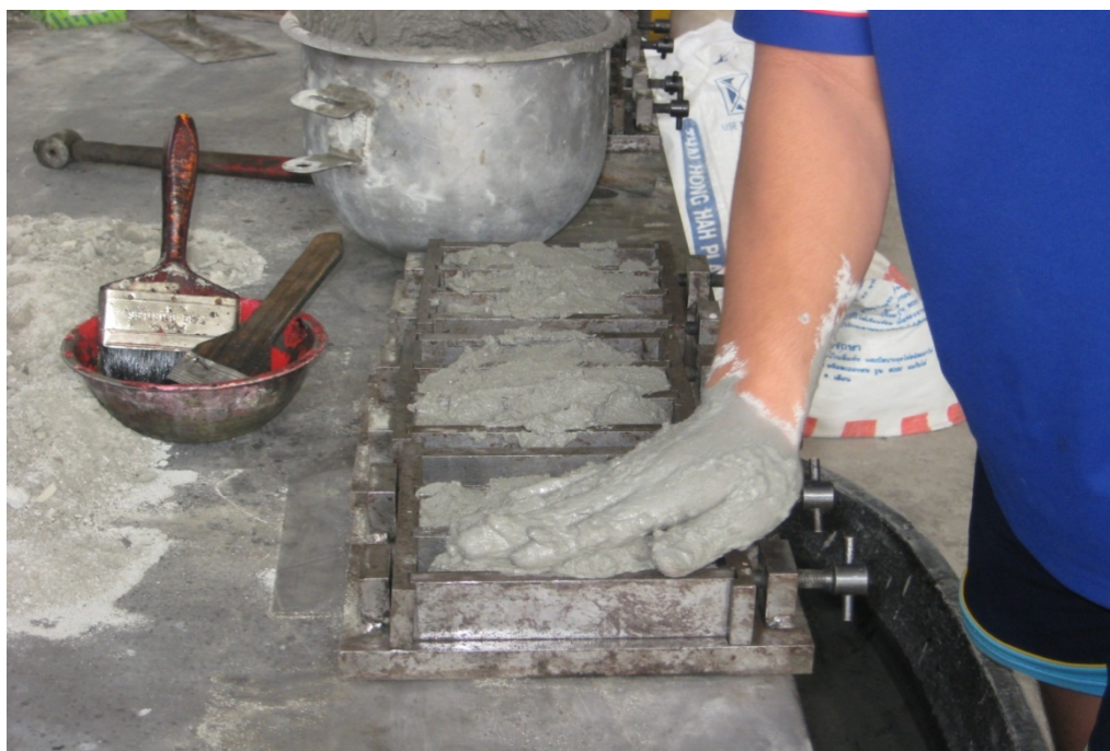
รูปผนวกที่ ค7 การเทมอร์ต้าร์ในแบบขนาด 4×4×16 เซนติเมตร
