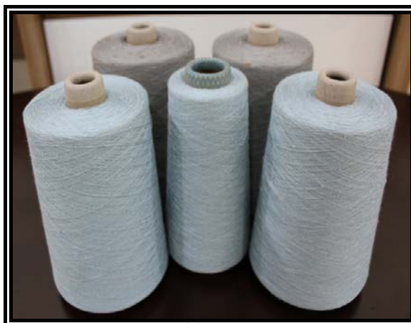
ภาพที่ 4.5 เส้นด้ายเศษไหมจากเครื่องทอเรเปียร์
