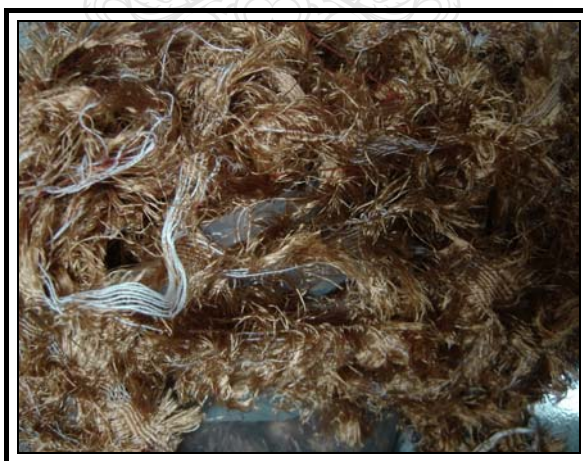
ภาพที่ 3.5 เศษไหมเส้นด้ายพุ่งจากริมผ้าเรโน (Reno) ที่ได้จากเครื่องทอผ้าแบบเรเปียร์
