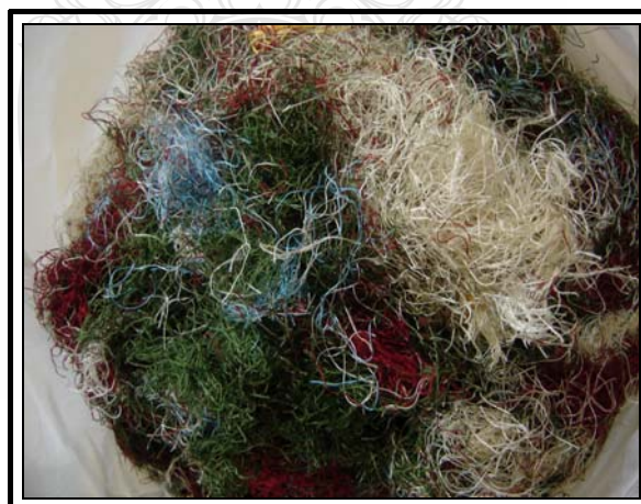
ภาพที่ 3.4 เศษไหมเส้นพุ่งจากเครื่องทอกี่กระตุก
