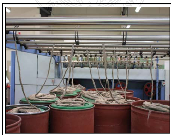
ภาพที่ 3.32 การป้อนสไลเวอร์เข้าด้านหลังเครื่องโรฟวิง (Roving machine)
