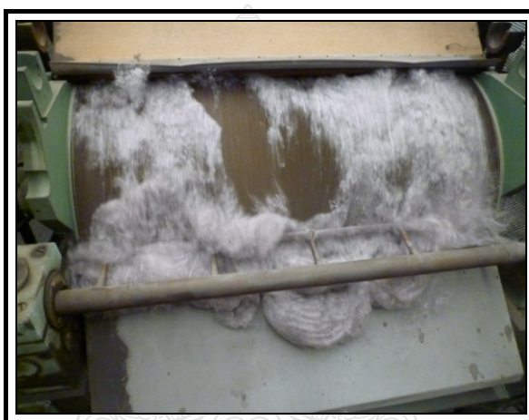
ภาพที่ 4.1 เส้นใยติดเนื่องจากการพ่นสารลดไฟฟ้าสถิตน้อยเกินไป
