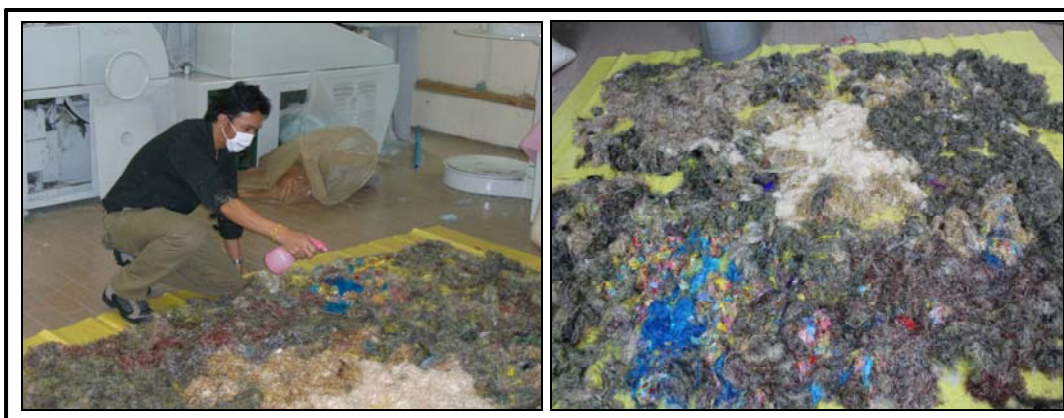
ภาพที่ 3.7 การตากเศษไหมให้แห้งหลังปั่นสารลดไฟฟ้าสถิต
