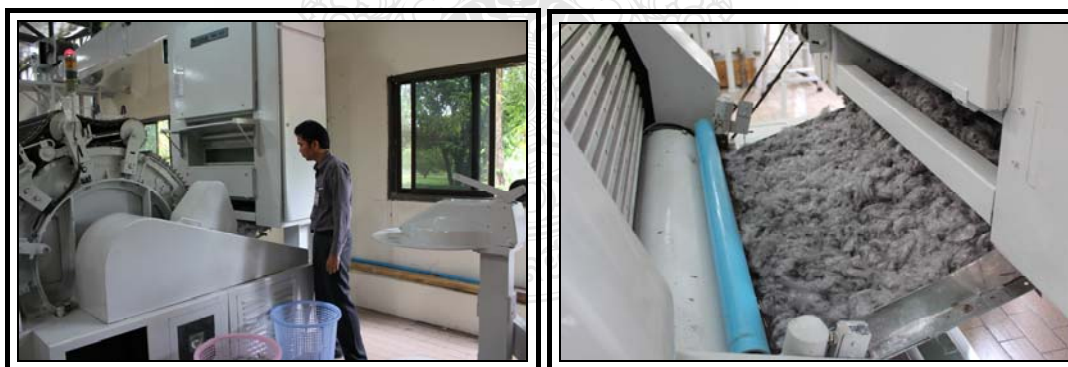
ภาพที่ 3.20 การส่งเส้นใยด้วยท่อลม (Chute feed)
