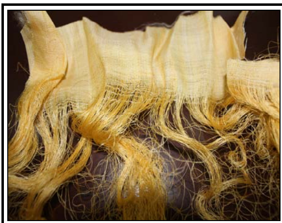
ภาพที่ 3.3 เศษไหมเส้นยืนจากเครื่องทอแบบกี่กระตุก
