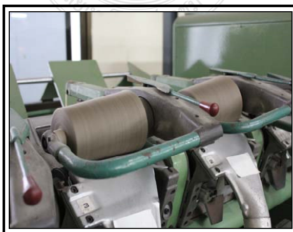
ภาพที่ 3.38 การพันเข้าหลอดด้ายใหญ่ (Cone)
