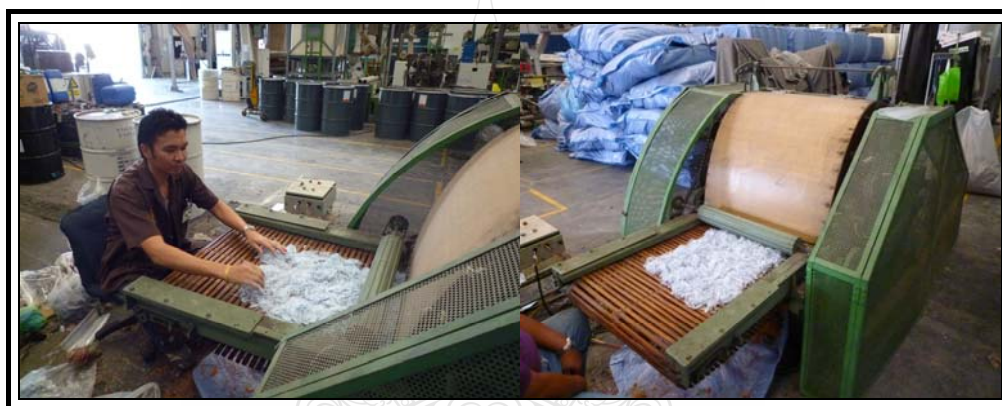
ภาพที่ 3.13 การป้อนเส้นใยเข้าด้านหลังเครื่องสาวใยขนาดเล็ก (Mini carding machine)
