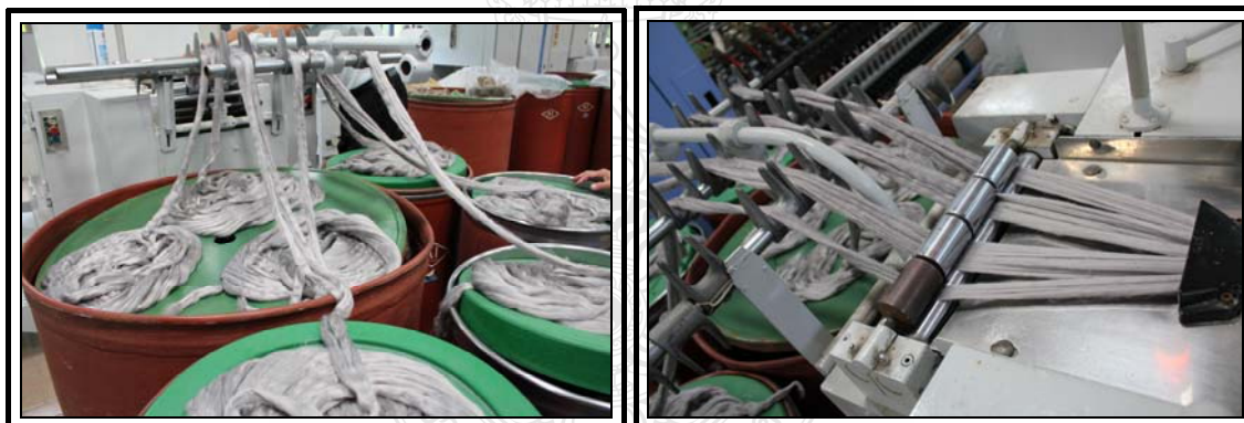
ภาพที่ 3.25 การป้อนสไลเวอร์เข้าเครื่องรีดปุย
