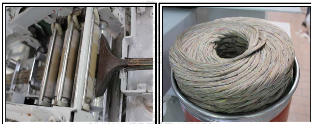
ภาพที่ 3.27 เส้นสไลเวอร์ที่ผ่านการดรีฟ
