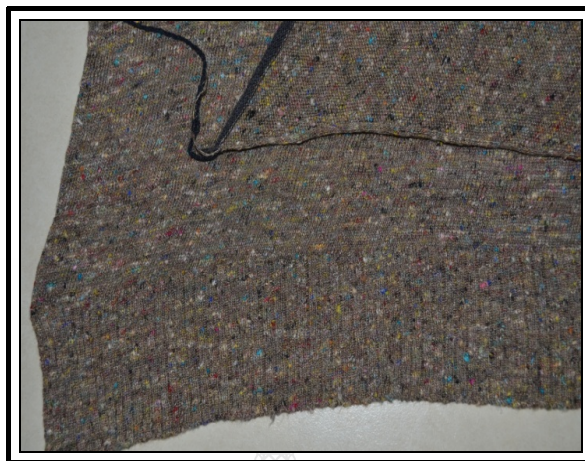
ภาพที่ 4.9 ผ้าถักจากเส้นด้ายเศษไหมเครื่องทอที่กระตุกด้วยเครื่องถัก Flat knitting machine
