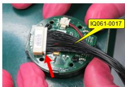
4.3 เสียบ Connector (IQ061-0017) ในแนบสนิทกับ Imager Board และส่งต่อไป Station ถัดไป
