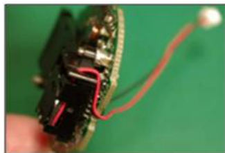
3.1 ทับสาย IR/AR SWITCHER อ้อมไปด้านหลังบอร์ด
