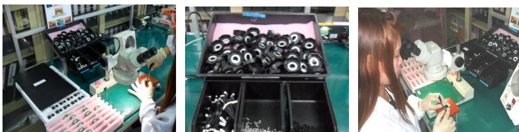
ภาพที่ 4.21 พื้นที่การทำงาน สถานีการผลิต Install IR/AR Switcher หลังทำการปรับปรุง
