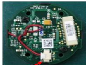
3.2 เสียบ Connector ของ IR/AR SWITCHER เข้าที่ J2 ปิดเกลียวสาย IR/AR SWITCHER ประมาณ 3-4 รอบ และพับให้แน่นกับบอร์ด
