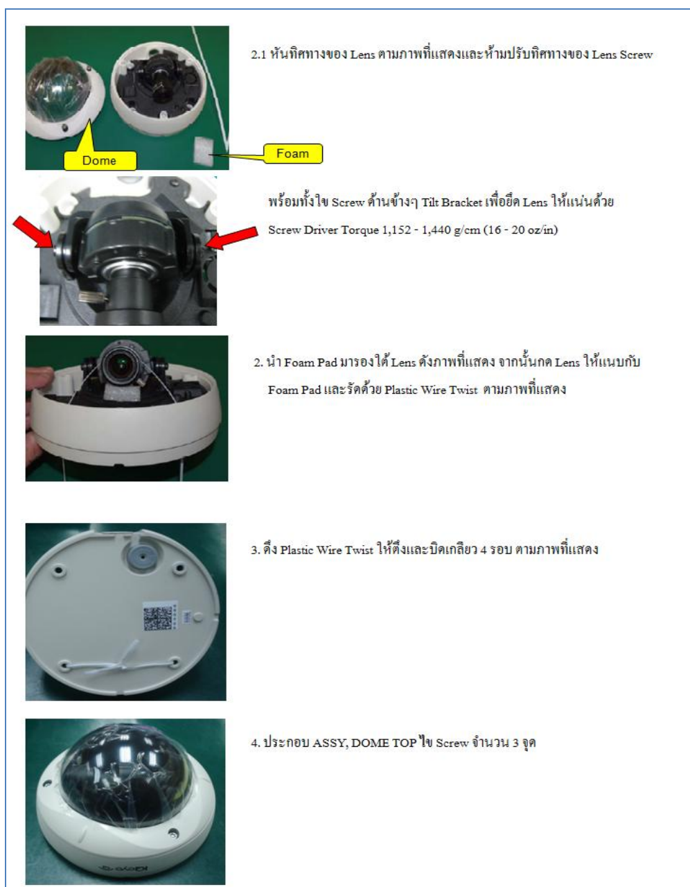
ภาพที่ 2.23 แสดงขั้นตอนการประกอบ Dome
