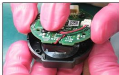
4.2 นำชุด Imager Board ใส่ลงไปใน IMAGER FRONT HOUSING (IQ041-0031A) โดยหันด้านที่มี IR/AR SWITCHER ลงไปดังรูป
