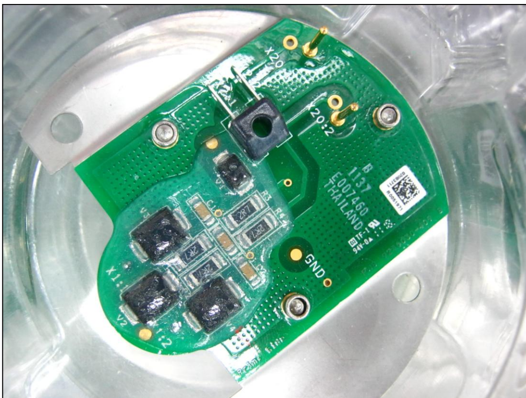
ภาพที่ 3.3 ภาพแสดงหลังการหยอดกาว RTV ลงบนแผ่นประกอบวงจรพิมพ์ (PCBA)
