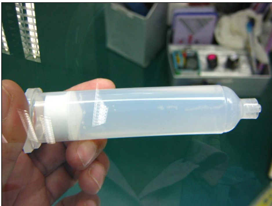
ภาพที่ 3.2 แสดงฟองอากาศในเนื้อกาว RTV
