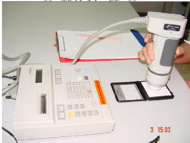
รูปที่ ข.7 เครื่องมือและการวัดระดับสีทองคำ (สถาบันเครื่องมือ 3 มหาวิทยาลัยเทคโนโลยีสุรนารี จังหวัด นครราชสีมา)
