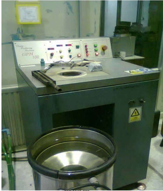
รูปที่ ข.2 เครื่องหลอมเทเม็ดยี่ห้อ Yasui
