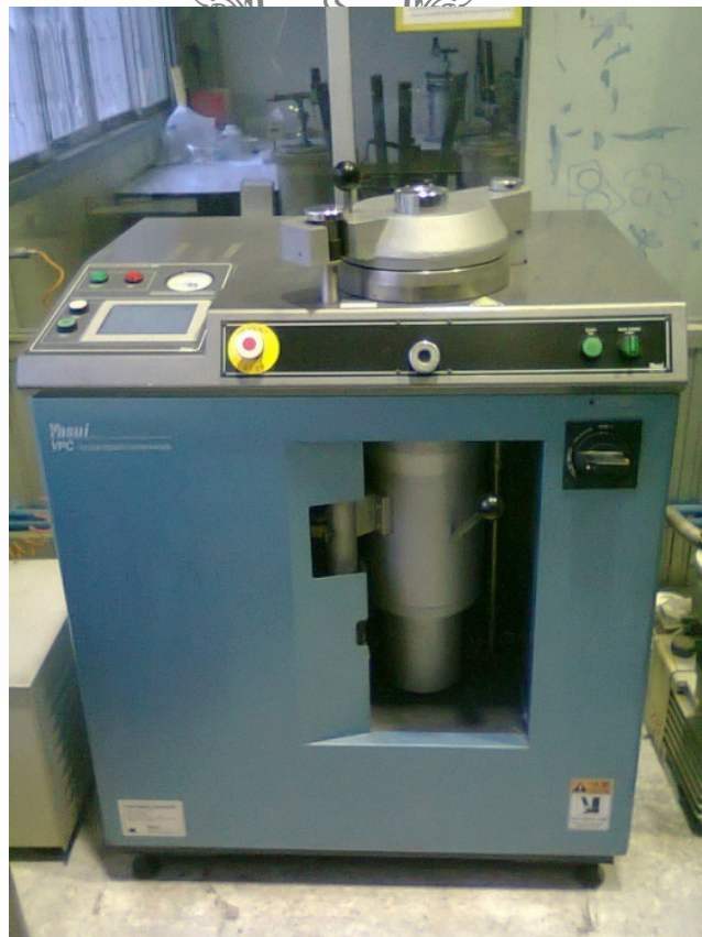
รูปที่ 3.8 เครื่องหล่อคูดสุญญากาศยี่ห้อ Yasui รุ่น K2
