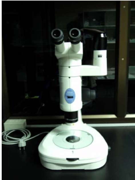
รูปที่ ข.8 การศึกษาสัณฐานเชิงพื้นผิวตัวอย่างพื้นผิวที่ถ่ายด้วยกล้อง Nikon SMZ 1500 ภายใต้อำนาจขยาย \times 11.25 (คณะวิทยาศาสตร์ ภาควิชาฟิสิกส์ มหาวิทยาลัยมหิดล ศาลายา)
