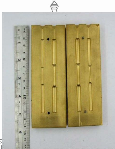
รูปที่ 3.5 โพรงแบบทองเหลืองสำหรับการฉีดขึ้นรูปตัวแบบเทียนสำหรับการวิเคราะห์ทดสอบความต้านแรงดึง
