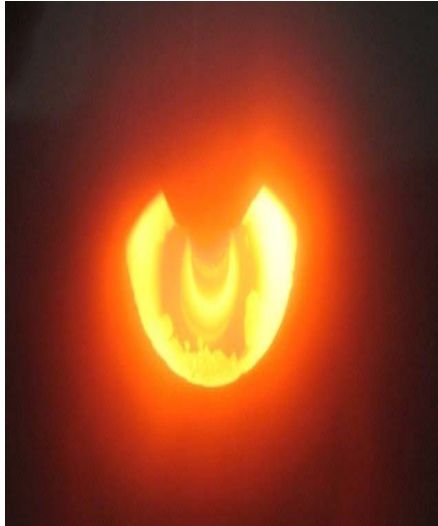
ข. นำโลหะในเบ้าหลอมภายใต้สภาวะสุญญากาศ
