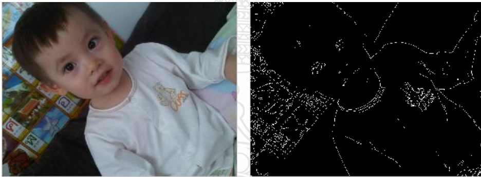
รูปที่ 2.22 ภาพที่ได้จากการหาขอบด้วยวิธีของ Prewitt
