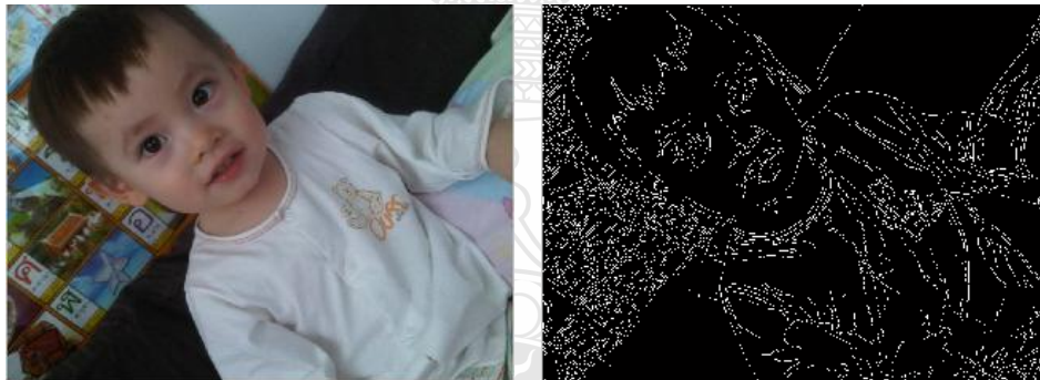
รูปที่ 2.24 ภาพที่ได้จากการหาขอบด้วยวิธีของ Canny
