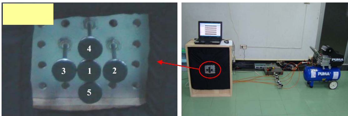
รูปที่ 5.1 ชุดวัดการกระจายแรงที่ใช้ชุดรับแรงเป็นแกนของกระบอกสูบจำนวน 5 ชุด
