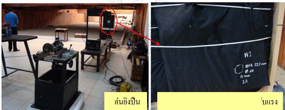
รูปที่ 5.2 การทดลองยิงด้วยกระสุนปืนจริงขนาด 9 มิลลิเมตร
