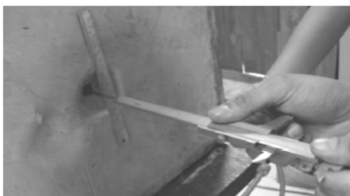
รูปที่ 2 ผลทดสอบแบบวิธี NIJ Standard-0101.04
