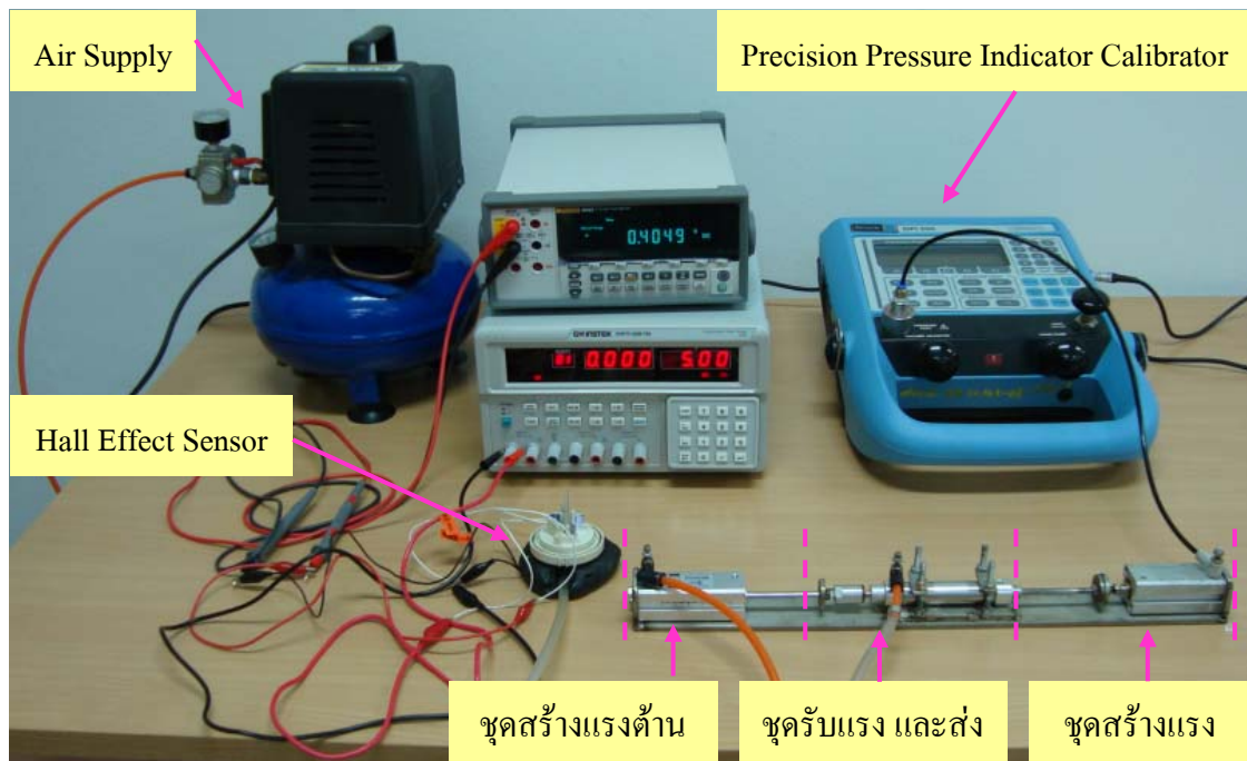
รูปที่ 3.10 อุปกรณ์สำหรับทดสอบความเป็นเชิงเส้นของทรานสดิวเซอร์วัดแรง
