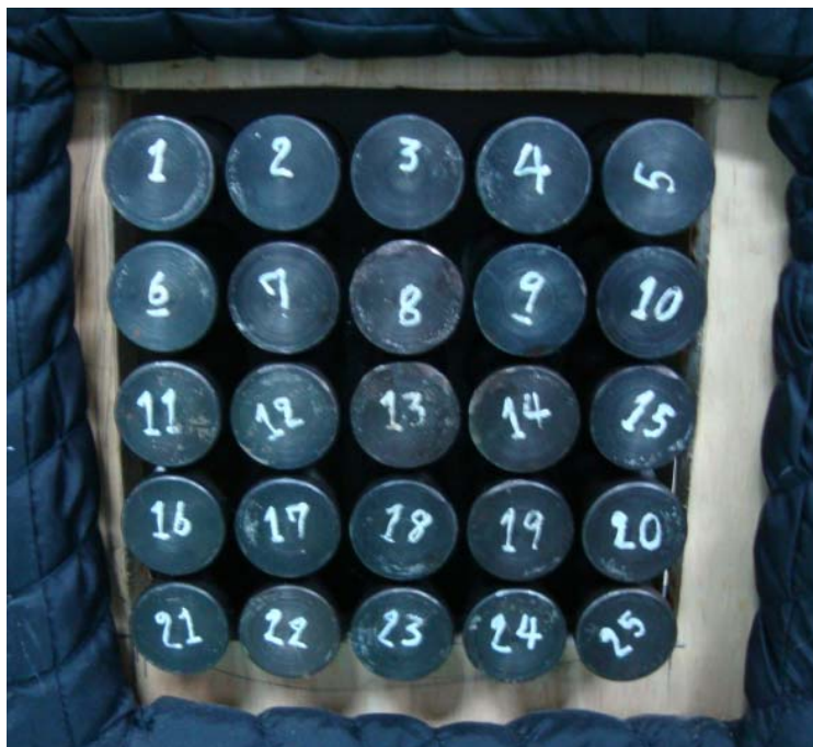
รูปที่ 4.5 ชุดรับแรงสร้างจากเหล็กเพลตันจำนวน 25 ชุด
