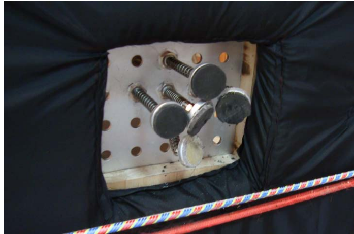
รูปที่ 5.4 ชุดรับแรงตัวที่ 1, 2 และ 5 เสียหายหลังทดสอบด้วยกระสุนปืนขนาด .44 Magnum
