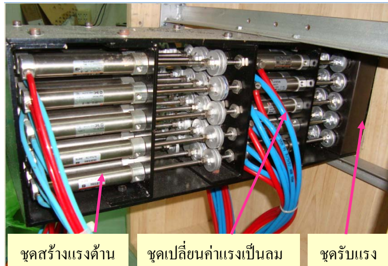
รูปที่ 4.6 ชุดเปลี่ยนค่าแรงเป็นลมกับชุดสร้างแรงดัน
