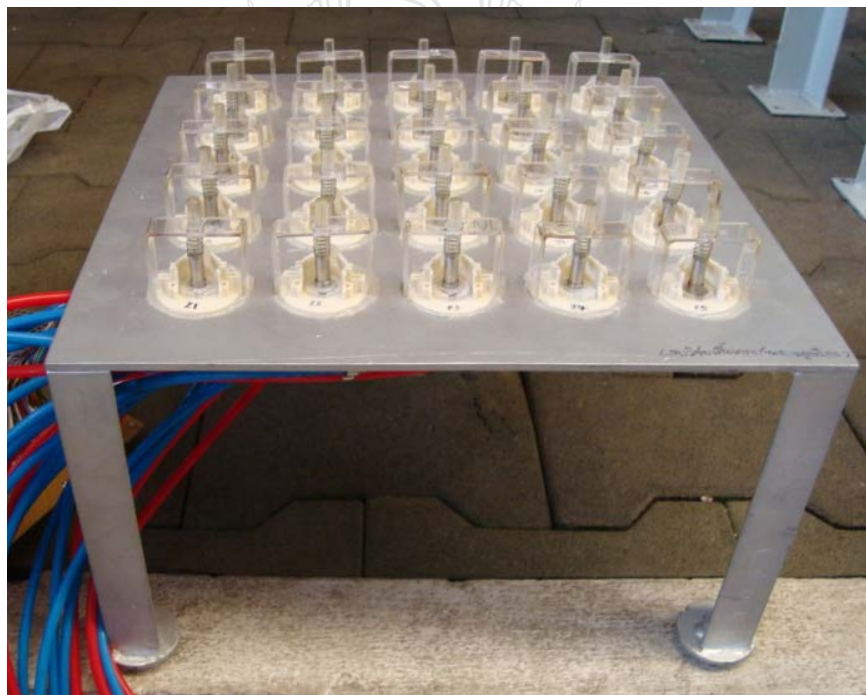
รูปที่ 4.3 ชุดตรวจจับความเข้มข้นแม่เหล็กฮอลล์เอฟเฟกต์เซ็นเซอร์แบบ Push-Push Approach ทั้งหมด 25 ชุด
