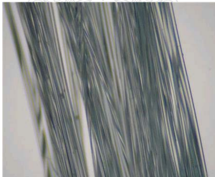
รูปที่ 4.5 ภาพตามยาวเส้นใย Nylon 66: 700dtex/108F
