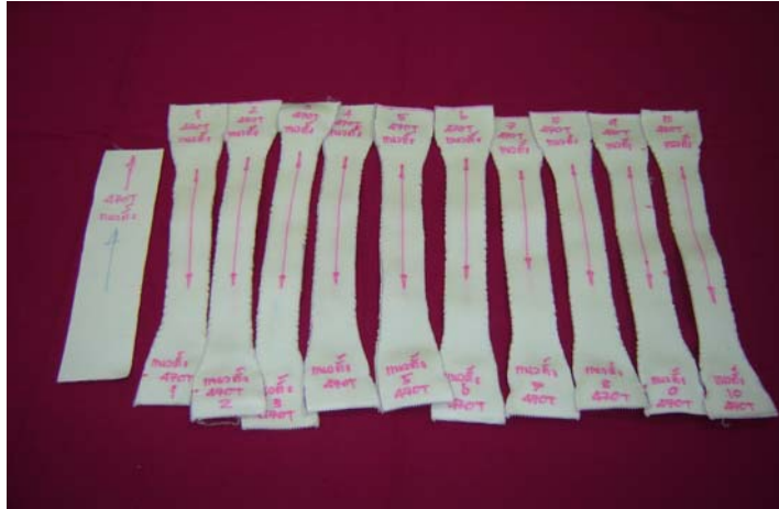
รูปที่ 3.52 ชิ้นทดสอบแนวตั้ง (Wale wise) เบอร์ 470dtex/ 72F
