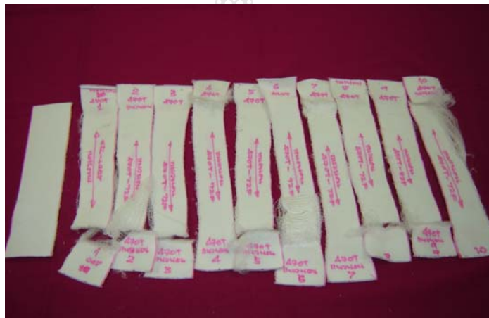
รูปที่ 3.53 ชิ้นทดสอบแนวนอน (Course wise) เบอร์ 470dtex/72F
