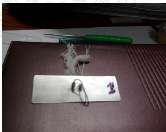
รูปที่ 3.3 การเตรียมชิ้นทดสอบภาพตัดตามขวาง
