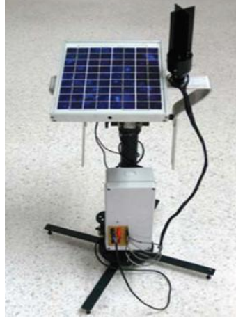
รูปที่ 2.2 ระบบติดตามดวงอาทิตย์จากอุปกรณ์ตรวจจับตำแหน่งเชิงดิจิทัลด้วยซีพีแอลดี [7]
